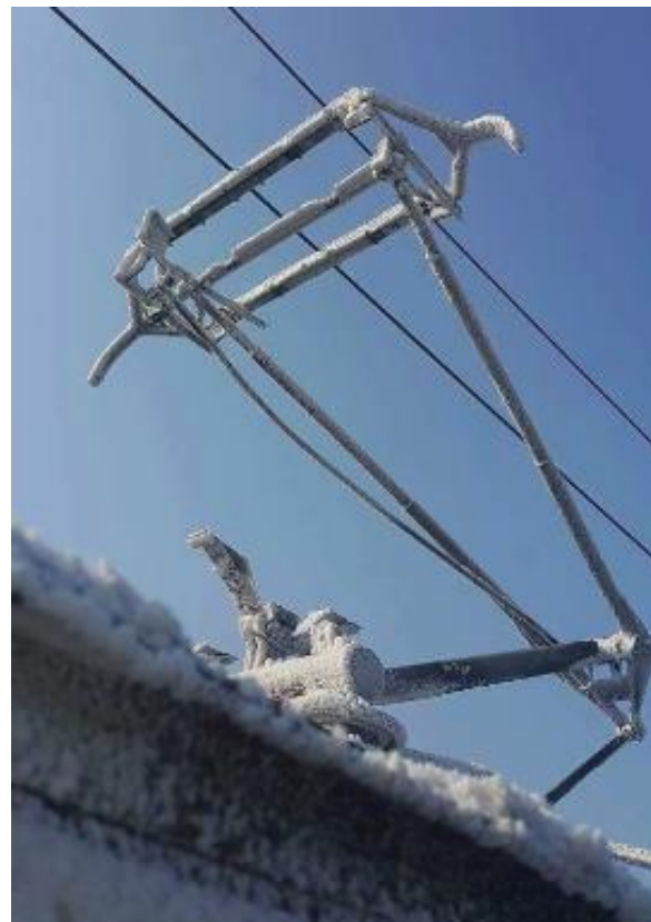
Foto XV.28. Pantograf înghețat (Sursa: monitorulbt.ro)
