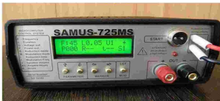
Foto XIII.1. Aparatul de electronarcoză Samus 725 MS utilizat pentru pescuitul științific
